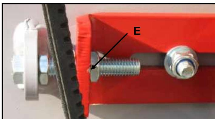
Vérifier qu'il n'y a pas de graisse sur les poulies et courroies (Usures prématurées). Vérifier l'alignement des courroies.
