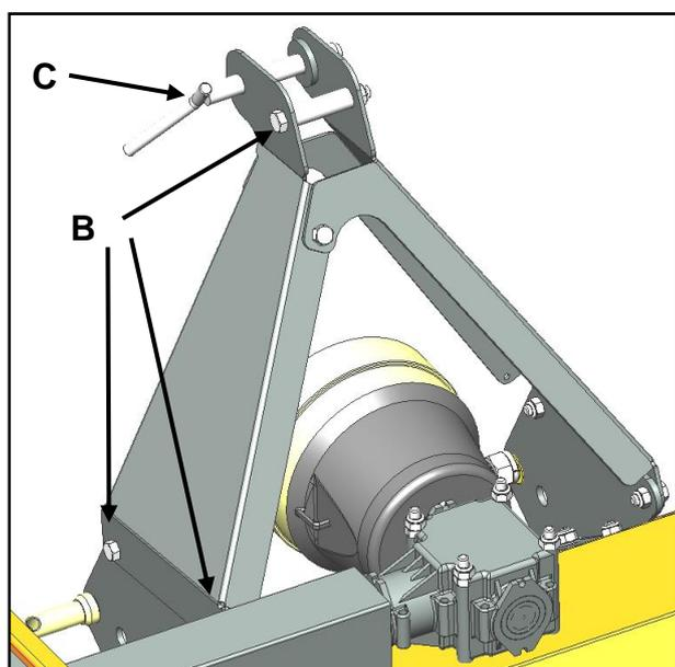
Monter la broche (C) Ø19 sur les tôles 3 points avec une goupille clips fournis.
